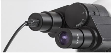
Fotocamera oculare fissata al tubo
